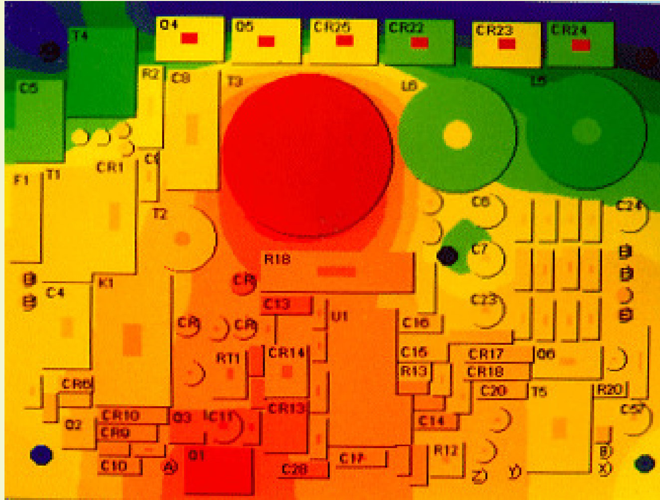
Hartă termică generată prin metode de management termic virtual
